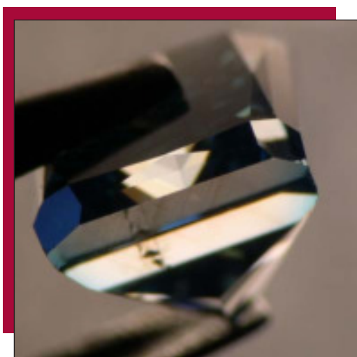
Figure 6 : Diamant bleu de couleur traitée. La couleur qui se concentre au niveau du rondiste est typique d'un traitement par faisceau d'électrons. Il est également possible de voir dans le diamant un veinage coloré brun qui révèle la couleur initiale de la gemme. Photo : E. Erel.
