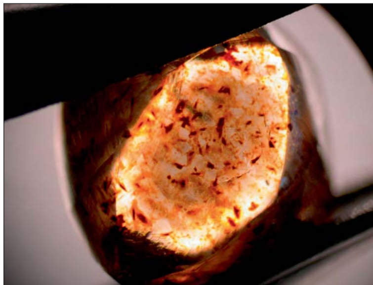
Figure 4 : Diamant brut naturel montrant une coloration orange superficielle répartie en taches. Celles-ci résultent de la combinaison d'une irradiation naturelle, par des particules, suivie d'une période de chauffage à plus de 500 degrés Celsius. Photo : E. Erel.
