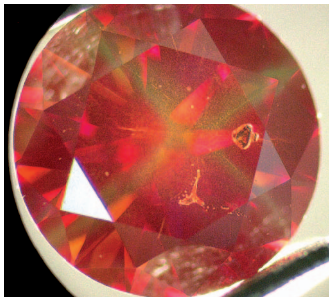
Figure 3 : Diamant rouge synthétique qui contient un nuage composé de points blancs microscopiques et des cristaux métalliques de tailles et formes variées. Si on éclaire ce diamant à l'aide d'une fibre optique, une croix fluorescente verte apparaît. Photo E. Erel.
