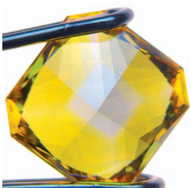
Figure 8 : Répartition cubo-octaédrique caractéristique de la couleur d'un diamant jaune synthétique. La zone centrale (cubique et incolore) est entourée par quatre secteurs octaédriques colorés. Photo E. Erel.
